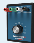
EVALUATOR 3 Interface 力 検証フレーム テスト、トラブルシューティングに使用 mV/V 計装
